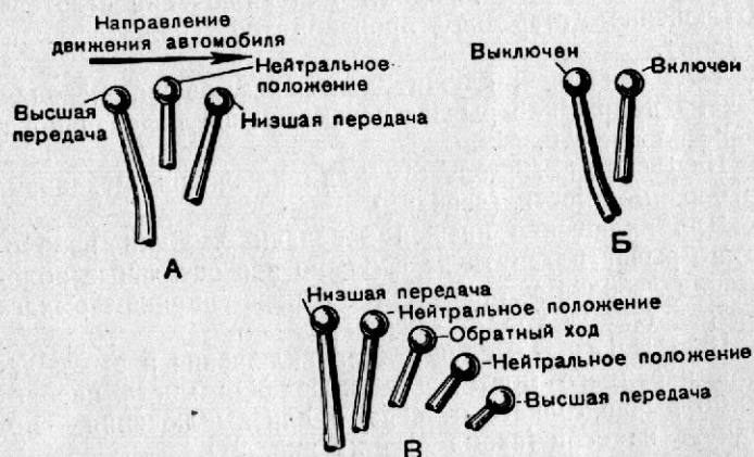
Рис. 27. Схема положений рычагов переключения раздаточной коробки переднего ведущего моста и механизма отбора мощности:
